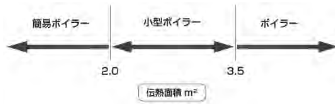
図 7 開放管又はゲージ圧力 0.05MPa 以下の U 形立管を蒸気部に取り付けたものによる区分（いずれも内径 25 mm 以上）
