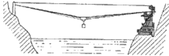
図 15 片側走行ケーブルクレーン
