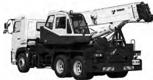
図 21 トラッククレーン
