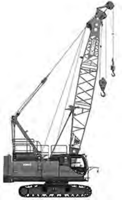
図 18 クローラークレーン
