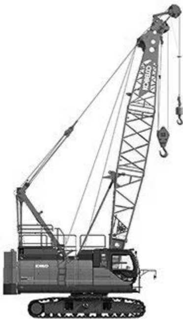
図 18 クローラークレーン
