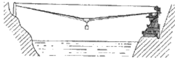
図 15 片側走行ケーブルクレーン
