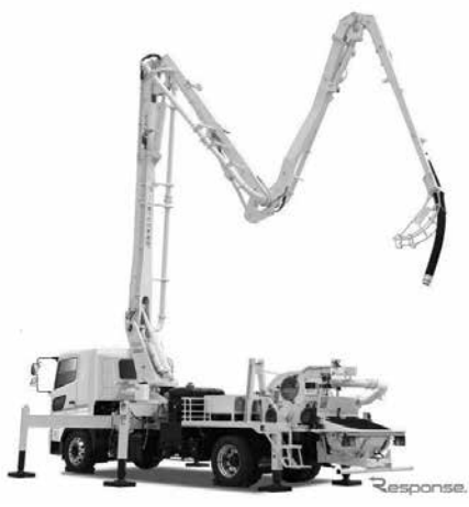
コンクリートポンプ車 61
