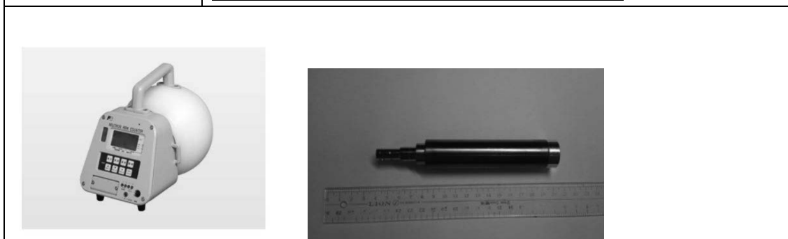
(左図) 比例計数管式サーベイメーター、(右図) 比例計数管の外観
