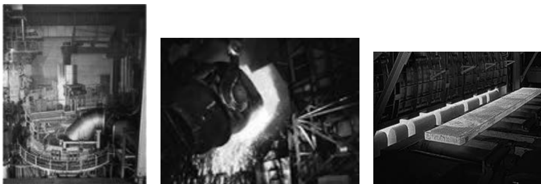
【図表 1-3-2：電気炉・転炉・加熱炉（左から）】
